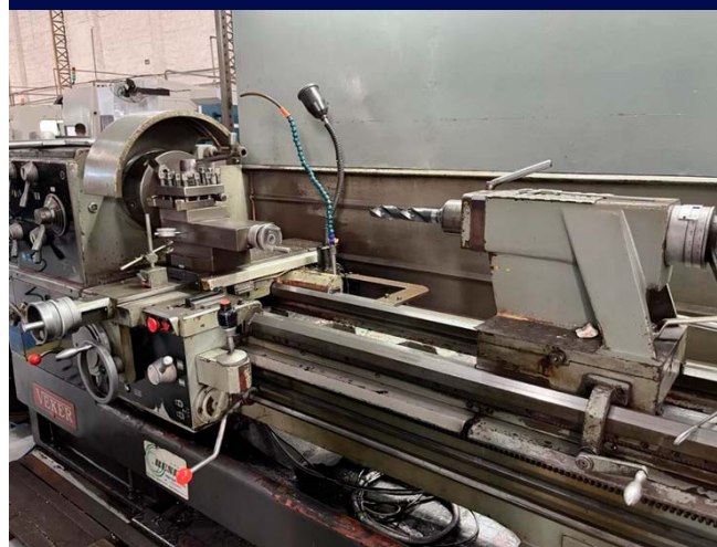
Figura 18 - Torno com as devidas proteções
