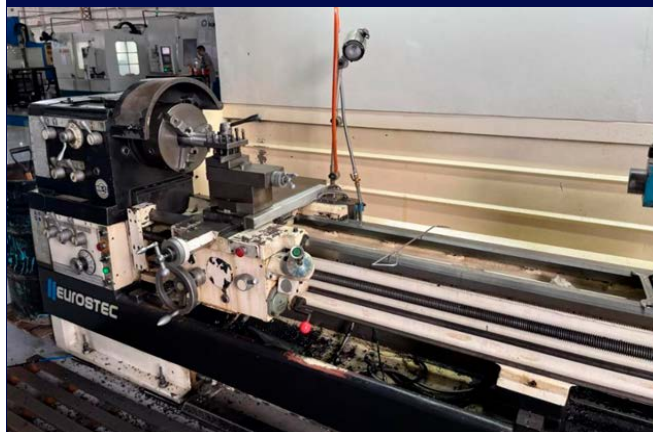
Figura 19 – Torno com espaço e local adequado
